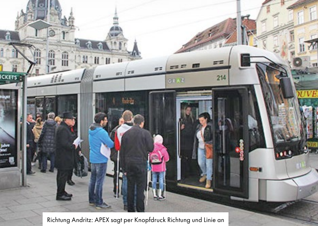
Außenlautsprecher sorgen für Durchsage auf Knopfdruck
